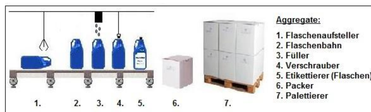
Abb. 5: Vereinfachter AV-Prozess an der Anlage G2
