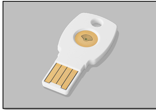
Abb. 18: Ein Google Titan Security-Key (Authentifikator in Originalgröße) 19
