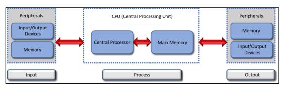
Fig. 21: Interfaces in the von Neumann Architecture
